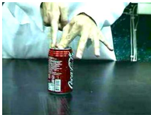
圖 3-3-16 將鋁罐以膠帶貼實 (第二個金屬罐壓縮實驗)
