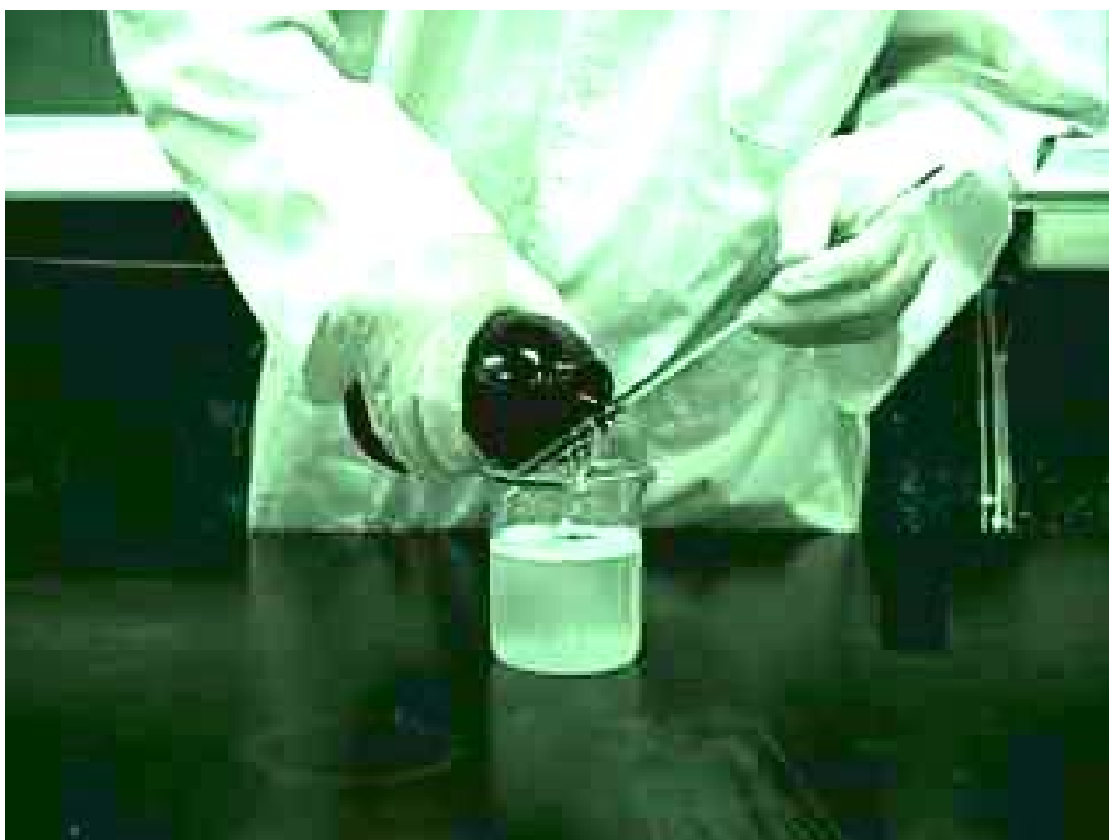
圖 3-3-4 將鹽酸加入裝水的燒杯中
