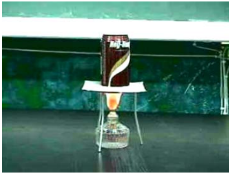
圖 3-3-9 加熱加入酒精的鋁罐 (第一個金屬罐壓縮實驗)
