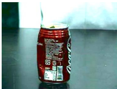
圖 3-3-20 再次觀察鋁罐的變化 (第二個金屬罐壓縮實驗)
