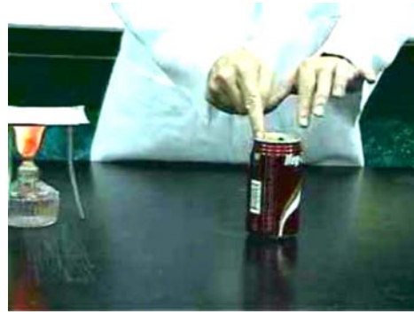
圖 3-3-10 將鋁罐以膠帶貼實 (第一個金屬罐壓縮實驗)
