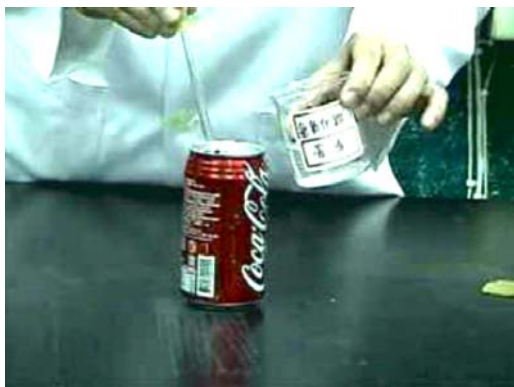
圖 3-3-15 將氫氧化鈉溶液加入鋁罐 (第二個金屬罐壓縮實驗)
