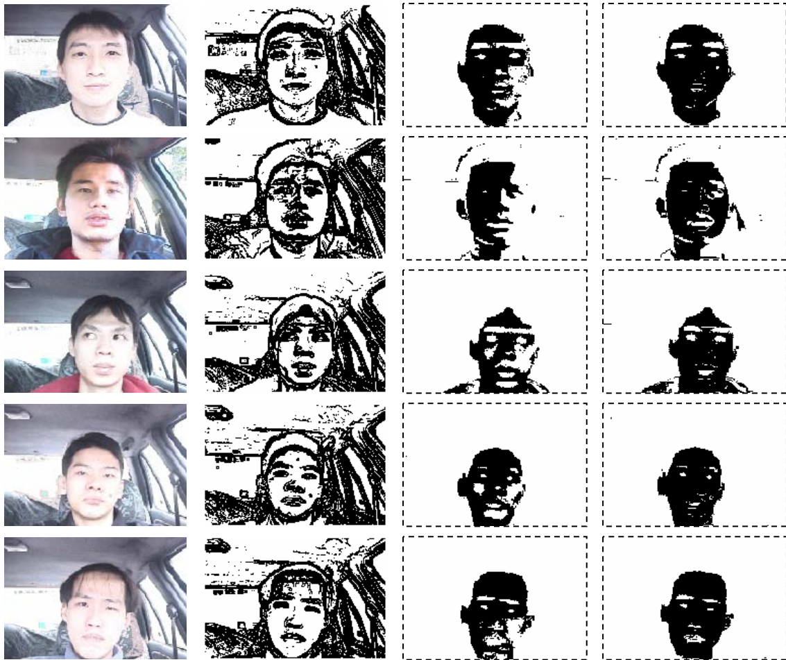
圖 3.6 修復破碎的膚色之實驗結果。其第一直排影像皆為強光下拍攝的，所以臉部右方顏色呈現白色，在偵測膚色時會呈現嚴重的破碎如第三直排影像。第二直排影像為邊線影像，臉部輪廓有清楚的邊線圍繞。經過修復動作後如第四直排影像，可呈現清晰的輪廓而找出近似橢圓。（第一~第三橫排為同一地點、同一時間拍攝的，而第四橫排則為不同時間拍攝的。）
