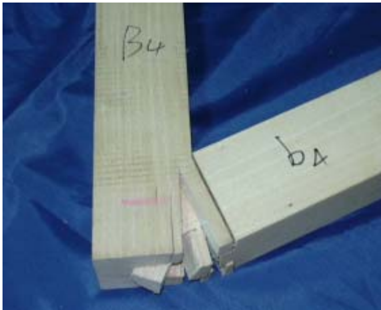
圖 3-7-7 實驗破壞 B 組試件呈現情形圖
