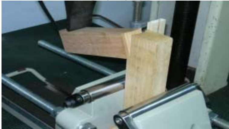
圖 3-7-1 萬能試驗機下壓進行抗彎強度試驗圖
