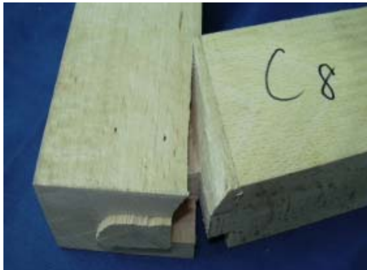
圖 3-7-8 實驗破壞 C 組試件呈現情形圖
