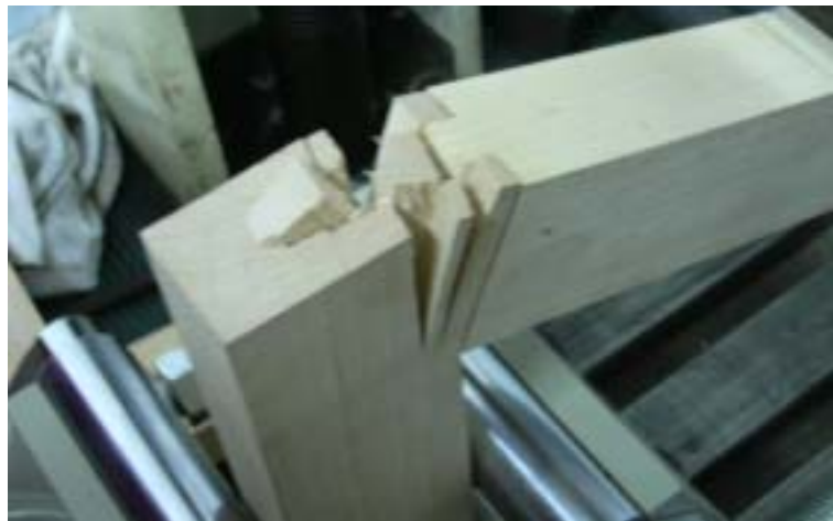
圖 3-7-5 下壓破壞撕裂圖
