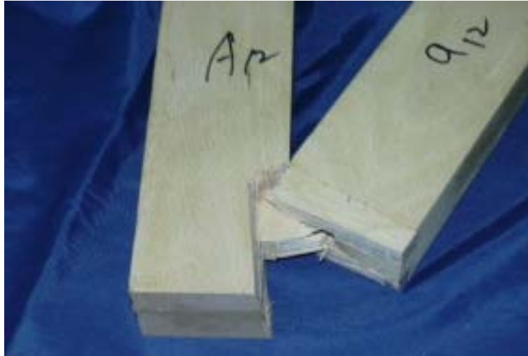
圖 3-7-6 實驗破壞 A 組試件呈現情形圖
