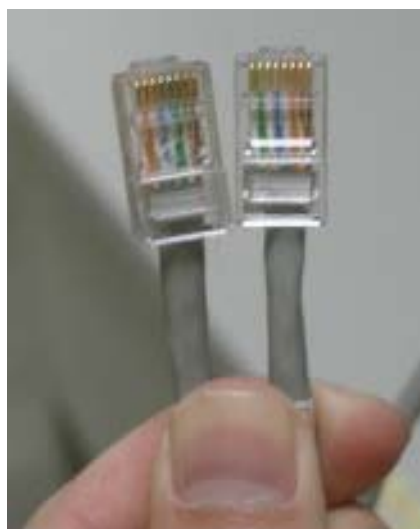
圖 6 壓製有跳線的網路線
