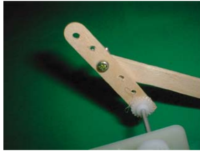
圖 4-2-8 調整曲柄與軸孔的距離
