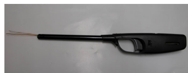
相片二 在手機型電子打火機(上圖)或多功能瓦斯電子點燃器(下圖)之前端接出兩條導線而成「改良型電子點燃器」
