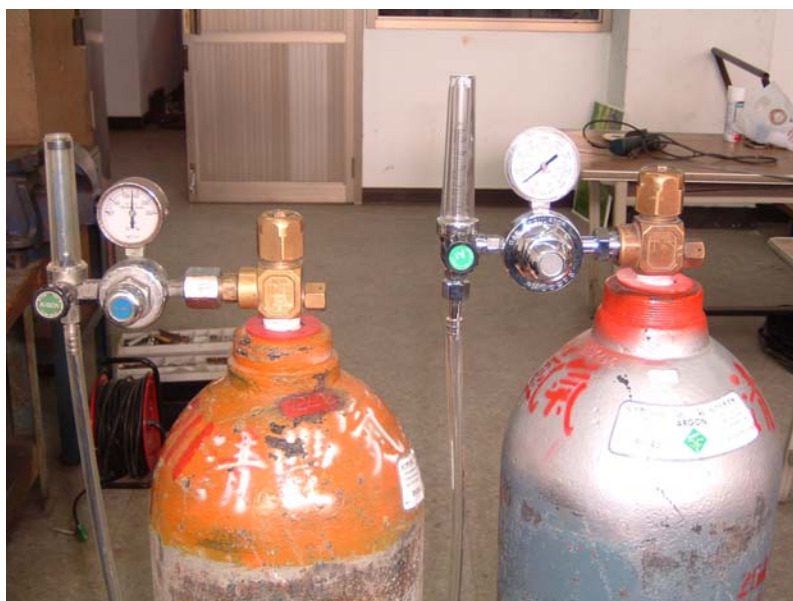
圖 3-6 保護氣體設備
