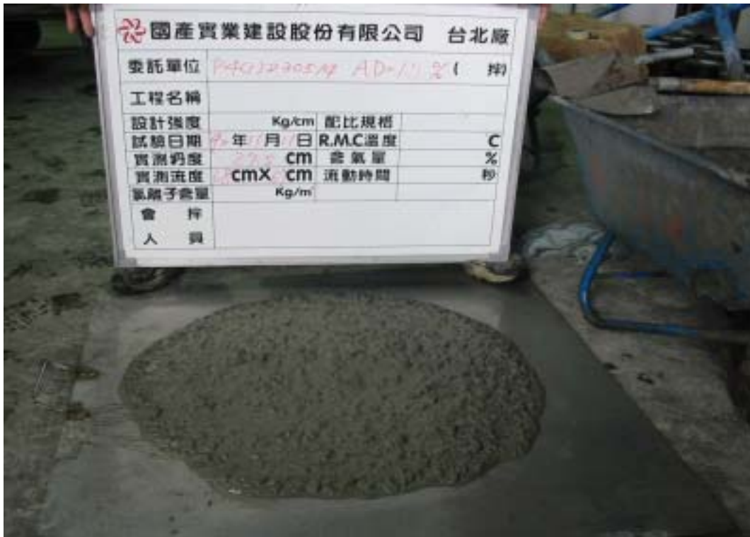
圖 4-5-7 OF2305 之混凝土坍流度(0min，SP=0.29wt%)
