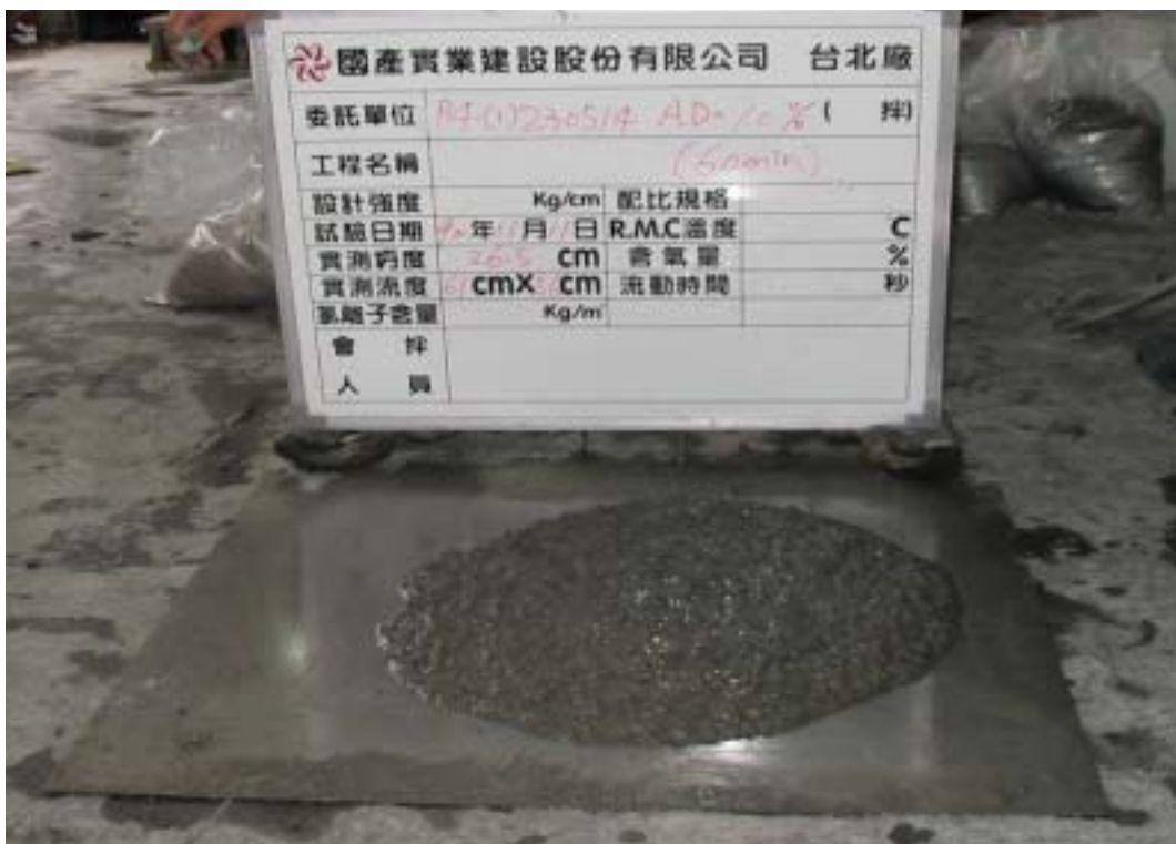
圖 4-5-8 OF2305 之混凝土坍流度(60min，SP=0.29wt%)
