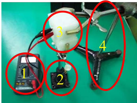
圖 3-14：檢驗電阻隨角度變化裝置
