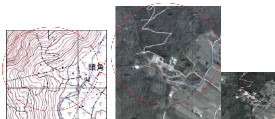
圖 4-1. 頭角扇(編號 019)，1:25000 地形圖等高線未呈現明確的弧形，但在 1:5000 的像片基本圖上等高線是弧形，故可判有沖積扇。
