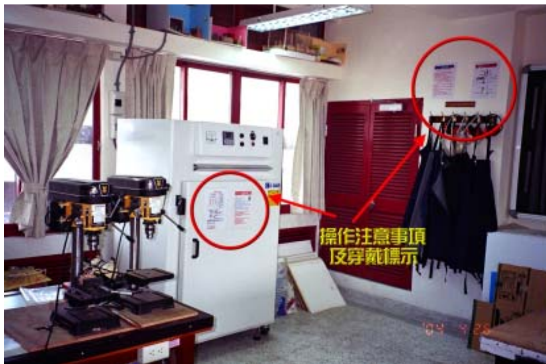
圖 14 生活科技教室（一）機具及防護器具上皆標示操作安全注意事項
