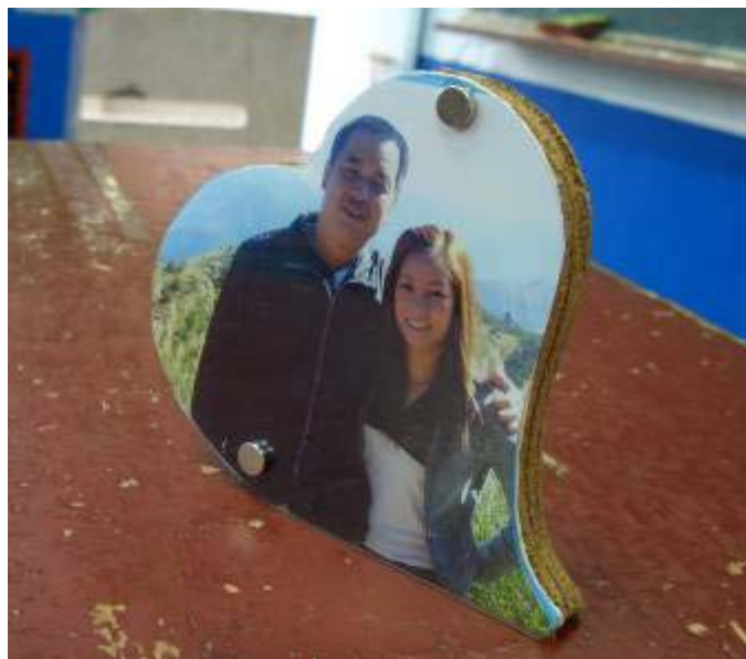
附圖1 利用磁鐵來夾持前方塑膠護片
