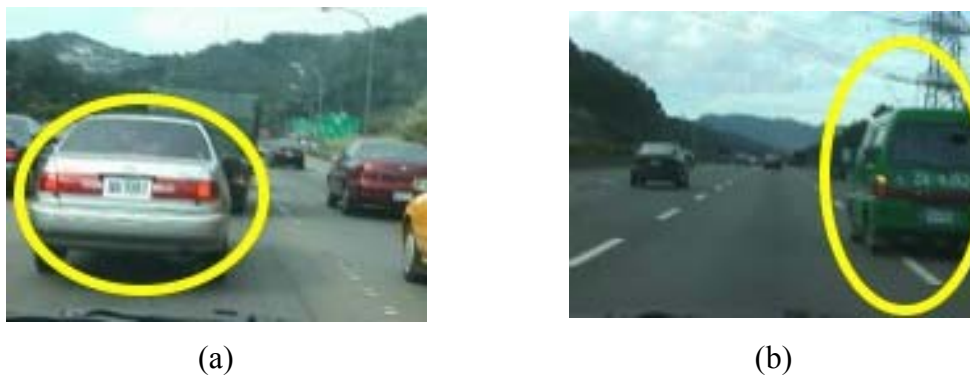
圖 1-2、高速公路上之動態障礙物：(a) 小於安全距離之前方車輛，(b) 其他車道中欲切換車道至前方車道之車輛。
