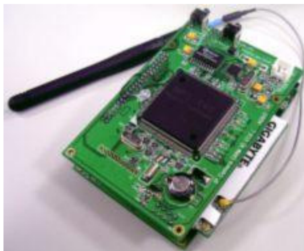
圖 5.4 IMAGIA 公司推出之 RDK 套件外觀圖(摘錄自[3])
