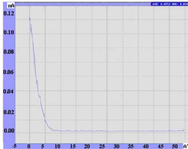
圖3-9 電流在 Z < 3 \text{ \AA} 內減小到一半，為很好的針尖
