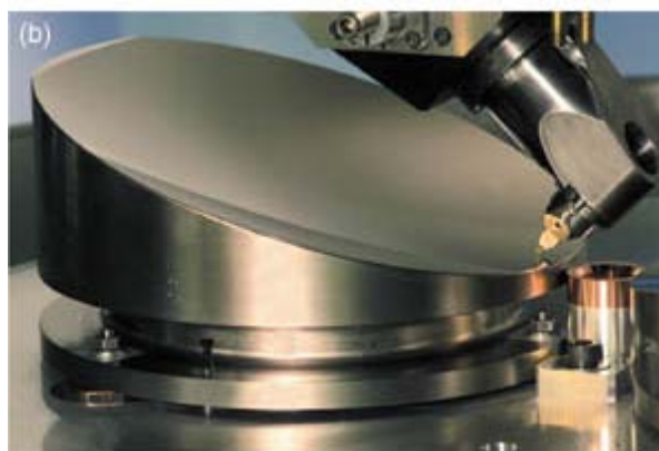
圖四 LODTM 型立式大型光學金剛石車床
