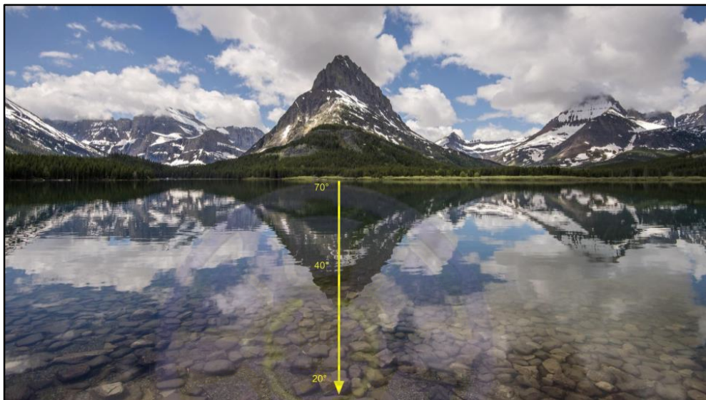
圖 9：菲涅耳效應示意圖，越遠入射角越大，光容易反射；越近入射角越小，光容易透射
