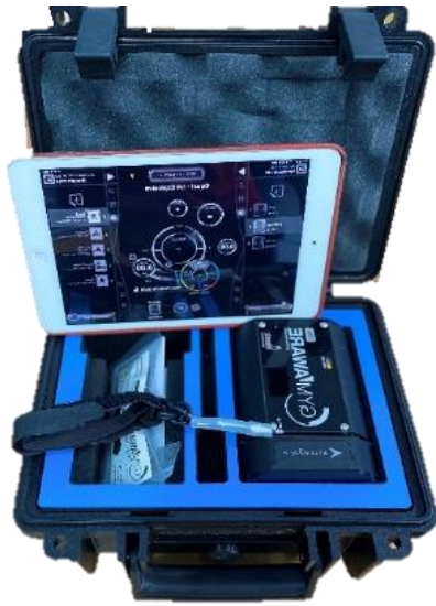
圖3-1. Gymaware 線性位移感測器
