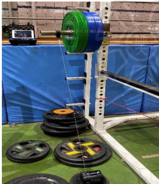
圖3-5. 實驗之線性位移感測器之設置
