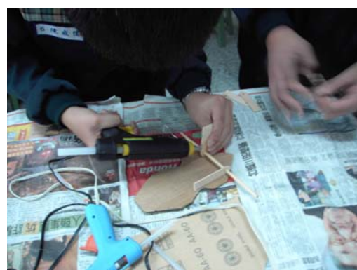
圖 7 裝上車軸座，用筷子協助定位
