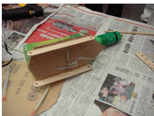
圖 6 固定保特瓶、底盤、車軸座
