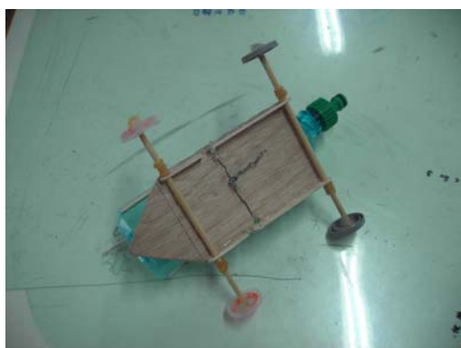
圖 4 鐵絲向內彎折法，車軸座在鐵絲外側
