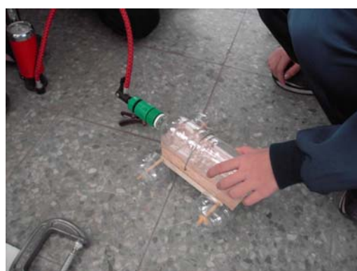
圖 17 將打氣筒連接至發射/充氣套環
