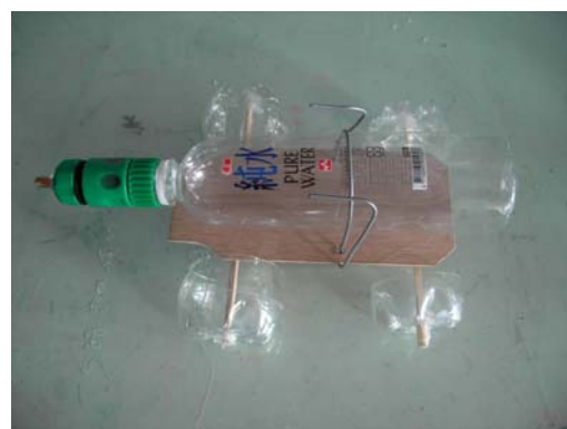
圖 5 鐵絲向外彎折法，車軸座在鐵絲內側，可做彎折造型
