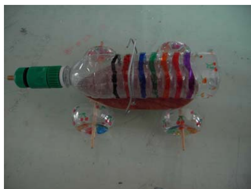
圖 13 作品三。底盤具圓弧流線。外觀以美工筆塗飾，惟車軸未裁切而過長
