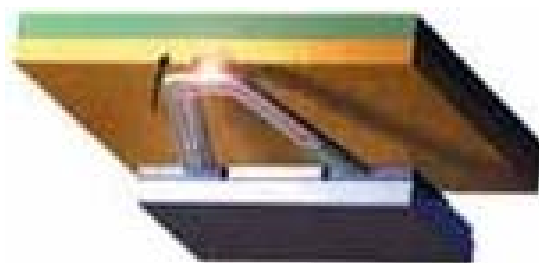
圖 1-6 Millipede 儲存元件清除一位元
