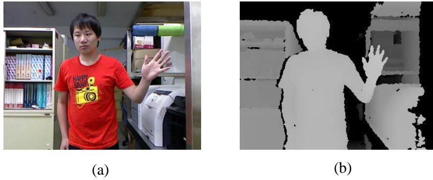
圖 2.7、利用 Kinect 所得到的影像(a)彩色影像(b)深度影像[李 12]
