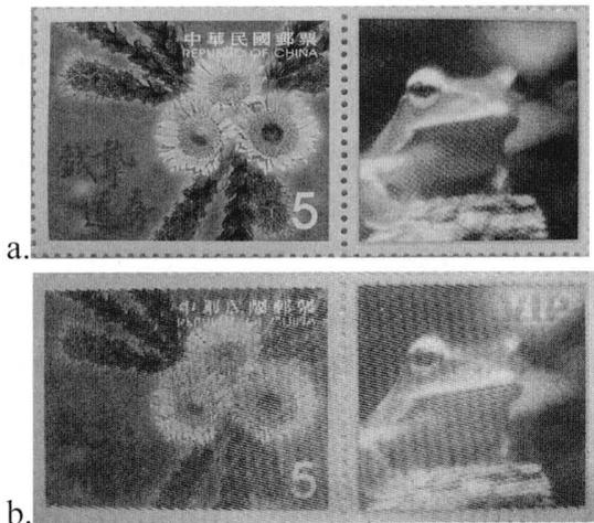
圖一 MCWT 加密後及解密後所觀察到的印刷影像 (a) 加密後的實際輸出影像 (b) 透過 75Lpi 光柵觀看的影像，在影像右上角可看出隱藏的 VIP 字樣
