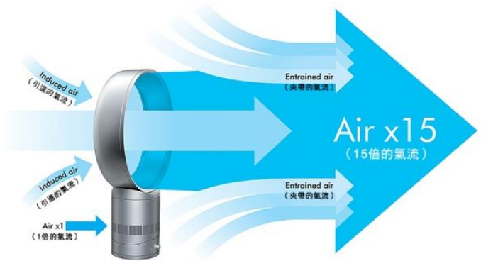
圖 4-14：戴森氣流倍增器的運作方式
