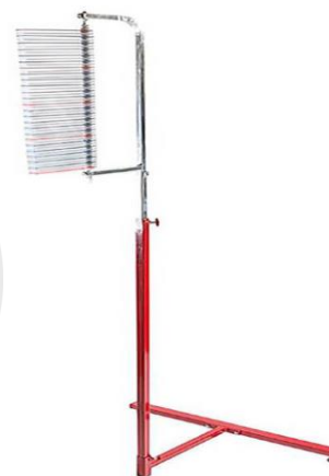
圖4 垂直跳躍測量系統
