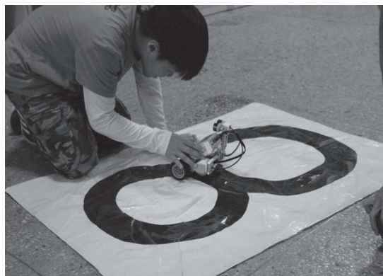
圖 5 運用感應器製作巡跡機器人
