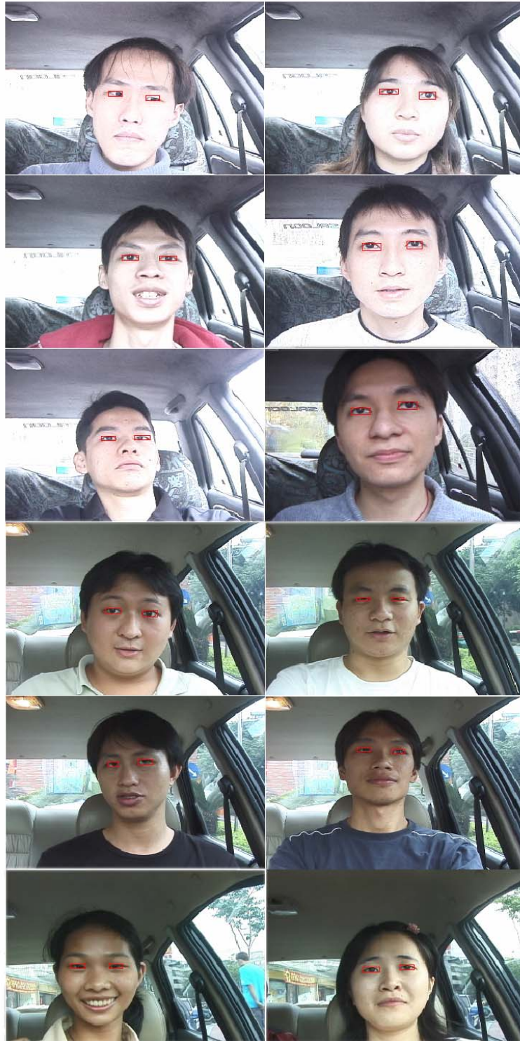
圖 4.9 在不同場景、不同光線與不同駕駛者的影像中偵測到成雙的眼睛，分別使用兩個小長方形框住。
