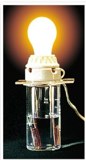
圖001食鹽水的導電性實驗
