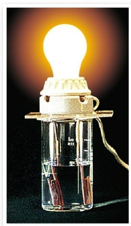
圖001食鹽水的導電性實驗
