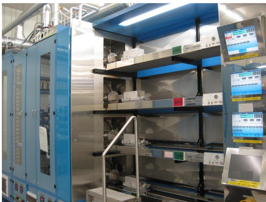
圖2.1 低壓化學氣相沉積系統。
