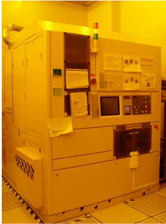
圖2.5 I-line曝光系統。
