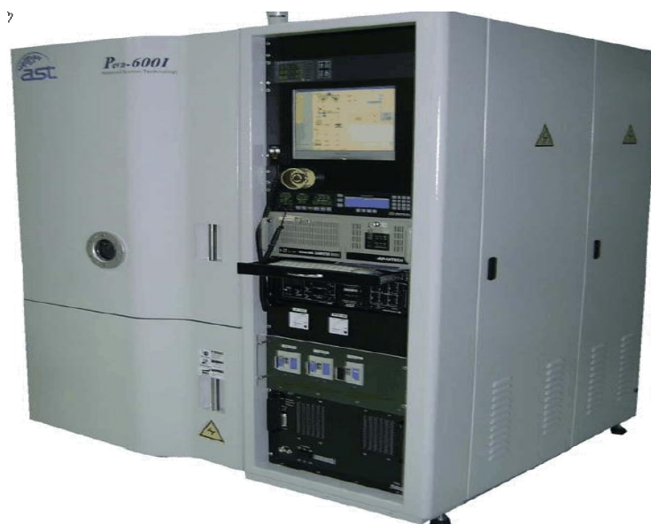
圖2.14 電子槍金屬蒸鍍系統。
