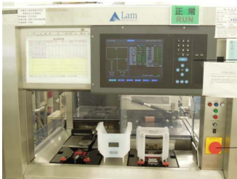
圖2.11 TCP乾式蝕刻矽機台。
