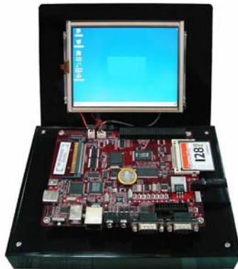
圖 3-2 XScale PXA255 嵌入式系統開發平台
