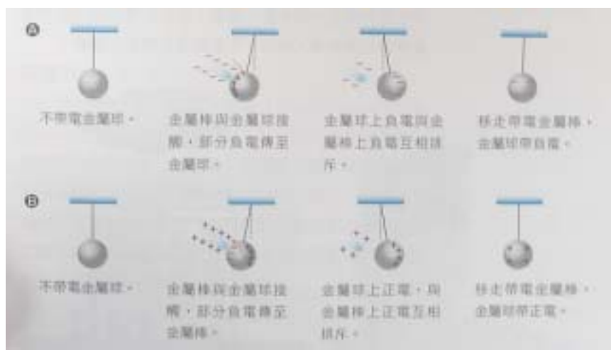
圖 4-3-11：康軒版—(a)感應起電帶負電 (b)感應起電帶正電 (c)接觸起電
