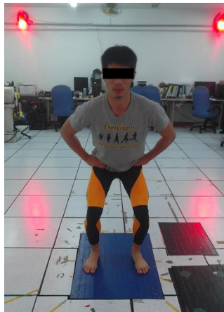
圖 3-6 測力板上進行垂直跳測驗
