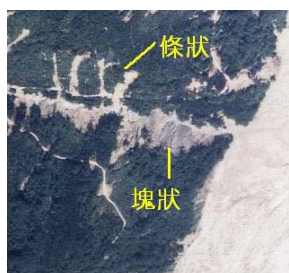
照片 1-1 航照上的崩塌地
