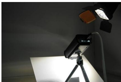
圖二 以分光色輻射照度工具量測 LED 光源之演色性
