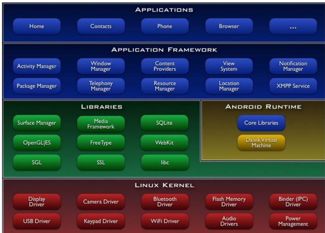
圖 2.1 Android 系統架構圖
