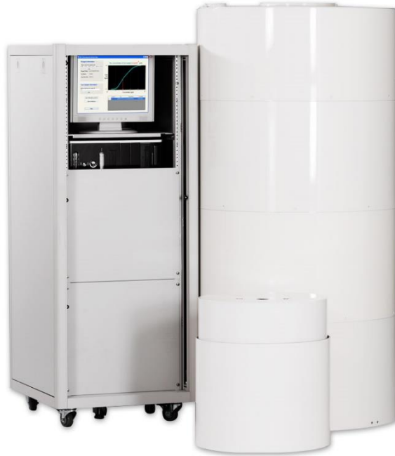
圖一. 單通道高溫超導免疫分析儀。第一套以高溫超導量子干涉元件為感測器的磁性標記免疫檢測系統 9 。
