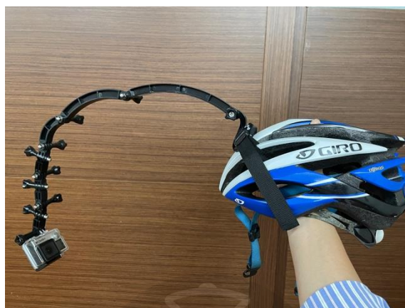
圖 3-2：運動攝影機與安全帽連接架設圖
