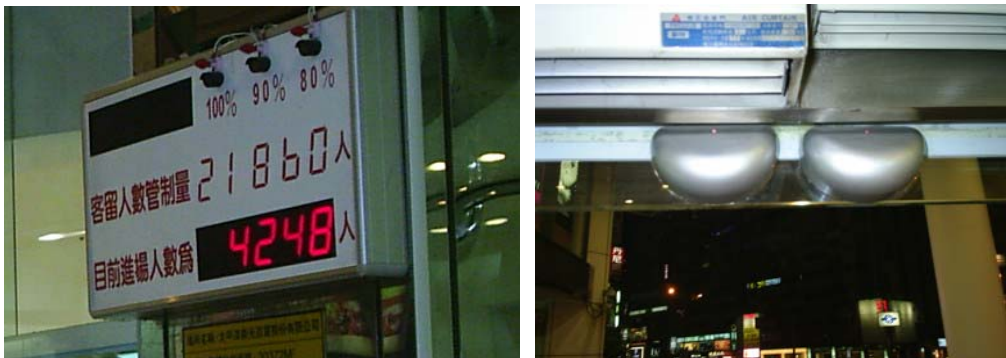
圖 1.2、SOGO 行人計數系統(a)行人計數看板 (b)兩個感測裝置
