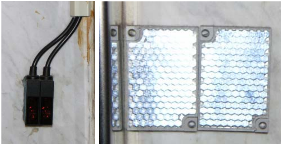
圖 1.1、錢櫃 KTV 人數統計系統 (a)紅外線感應器 (b)紅外線反射板
