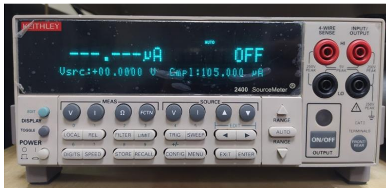
圖 3-10. Keithley 2400 多功能電源電表
