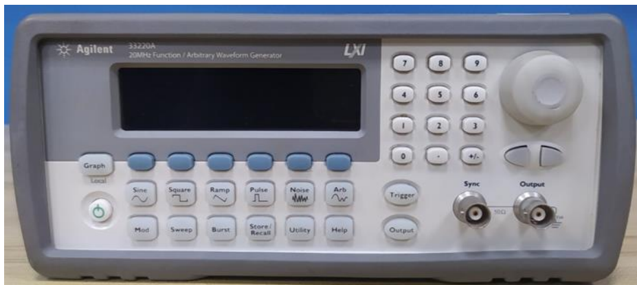
圖 3-12. Agilent 33220A 訊號產生器
