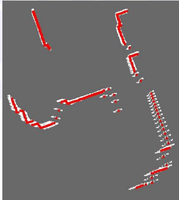
圖 4-5 PSO 演化數代後每個粒子的旋轉位移示意圖
