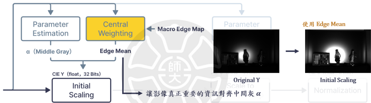
圖 3-7 影像初始縮放流程與影像處理示意圖
