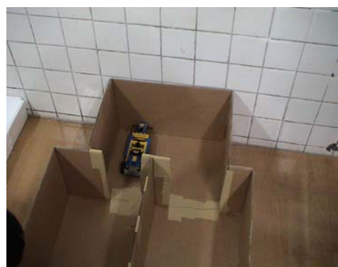
圖 4-5 機器車碰到障礙準備迴轉
