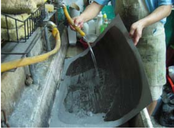
圖四十：此時沖水即可顯現含油的圖像部分
