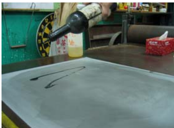
圖三十八：版面上一層層薄薄的黑油
