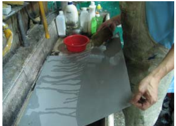
圖十二：用印刷海綿沾潔版液均勻擦拭整片鋁版
