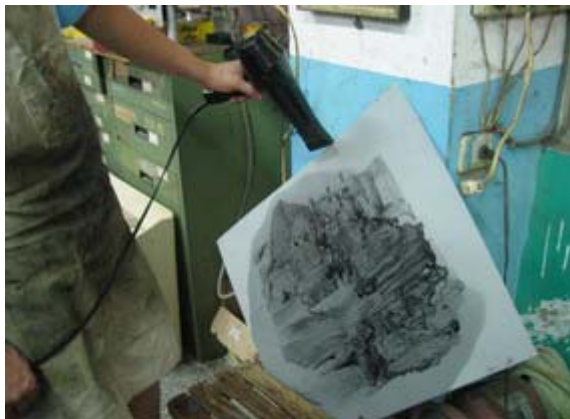
圖二十九：用吹風機將煤油吹乾
