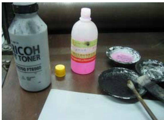
圖十五：影印碳粉酒精碟子和毛刷為基本工具
