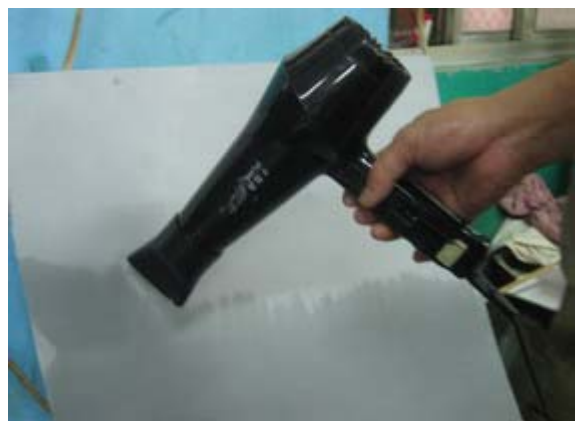
圖十四：立刻吹乾以免版面留下水痕
