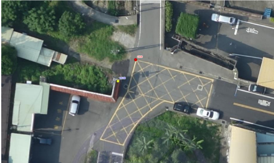
圖 20 ML08 已知控制點(黃色)與 CK08 無正射影檢檢核點(紅色)
