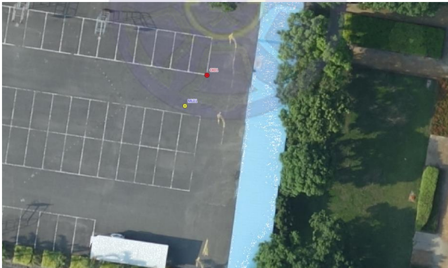
圖 21 ML01 已知控制點(黃色)與 CK01 無正射影檢檢核點(紅色)
