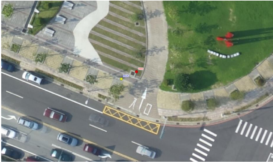
圖 22 ML05 已知控制點(黃色)與 CK05 無正射影檢檢核點(紅色)
