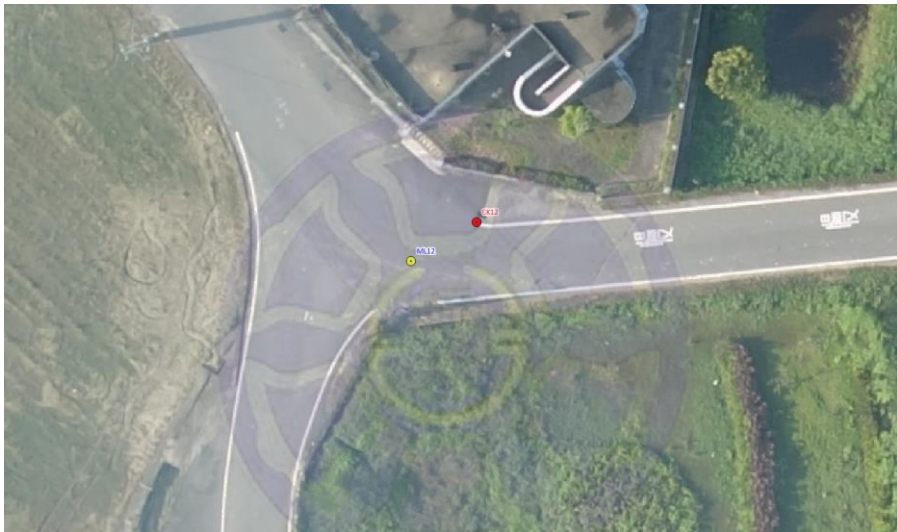
圖 23 ML12 已知控制點(黃色)與 CK12 無正射影檢檢核點(紅色)
