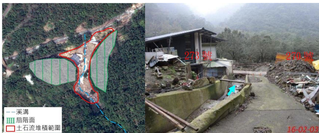
圖 3-38 PG35 土石流災後正射影像(右)以及從上游往下游拍攝之土石流堆積近照(左)(照片轉載自周憲德等，2016)
