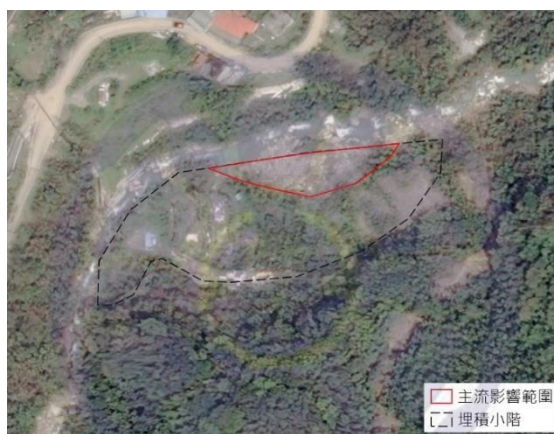
圖 3-21 磺窟溪受蘇迪勒颱風影響之埋積小階正射影像(位置參見圖 3-17c)
