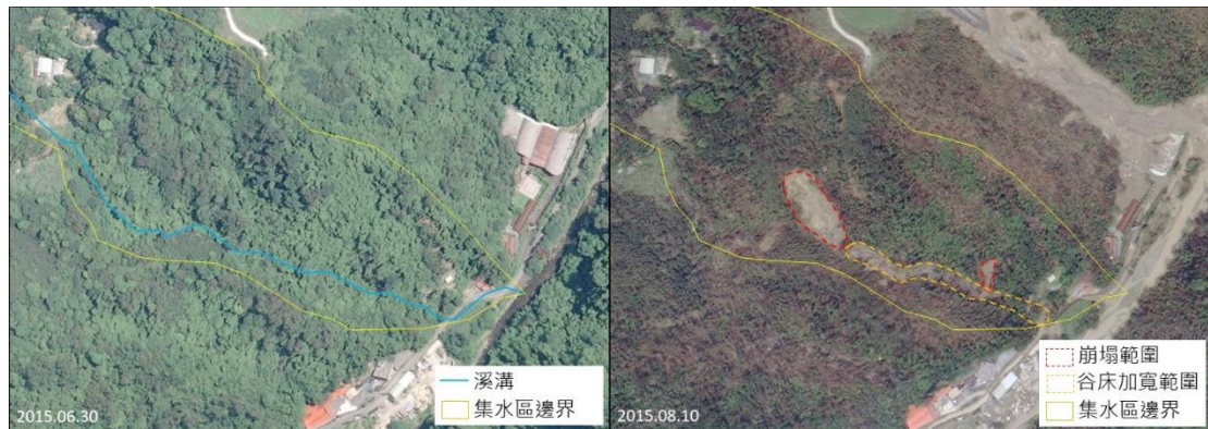
圖 3-28 PG05 集水區颱風前後之正射影像(位置參見圖 3-24) 蘇迪勒颱風前(左)谷床狹窄且植生茂密(圖 3-29a)。蘇迪勒颱風後(右)集水區發生崩塌，大量土砂沖刷河谷致使谷床加寬。目前此溪溝已進行整治(圖 3-29b)。
