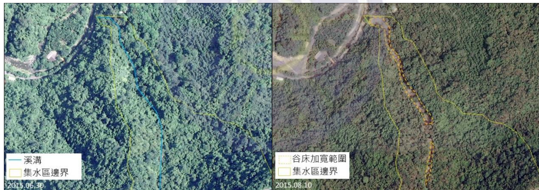
圖 3-31 PG46 集水區颱風前後之正射影像(位置參見圖 3-24) 蘇迪勒颱風前(左圖)該溪溝植生茂密(圖 3-32a)。蘇迪勒颱風後(右圖)集水區內無崩塌發生，但有明顯沖蝕加寬的情形。目前本土石流溪溝已有整治(圖 3-32b)。
