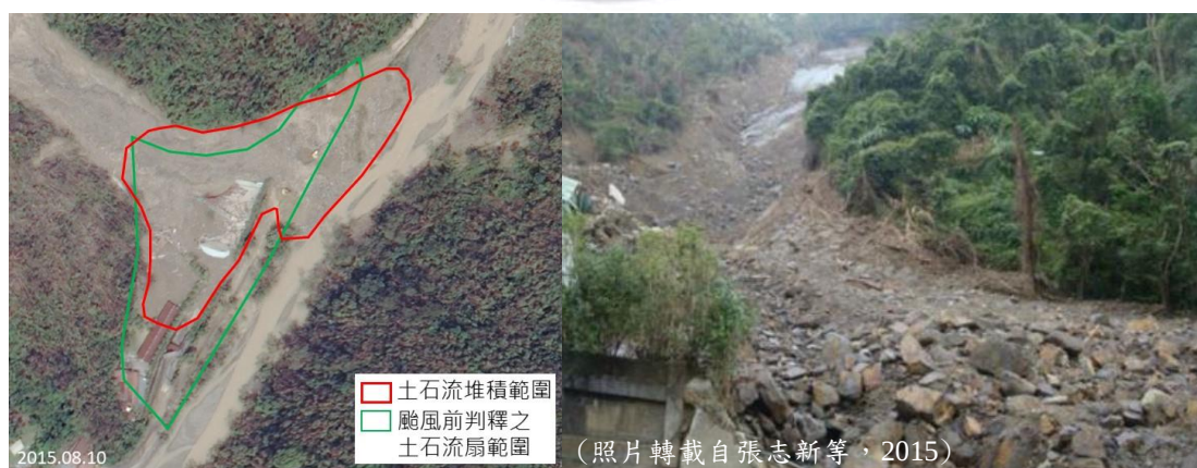
圖 3-33 PG04 土石流扇災後正射影像(右)與土石流堆積近照(左)。 本次颱風事件造成大量土砂堆積於土石流扇之扇面，並沖毀扇面上之房舍。
