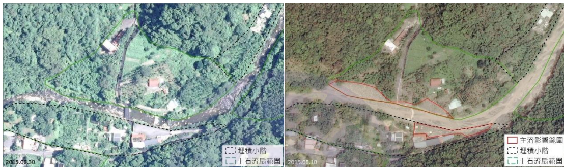
圖 3-11 蘇迪勒颱風前後平廣溪中游河段局部放大之正射影像 (位置參見圖 3-9 白框 b)
