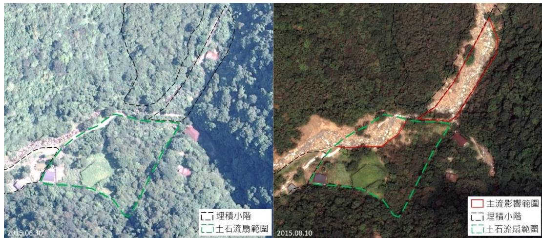
圖 3-6 平廣溪上游河段颱風前後影像(位置參見圖 3-3 白框 a) 從颱風後之影像可明顯看出土石流扇與埋積小階被側蝕、淤埋之狀況。
