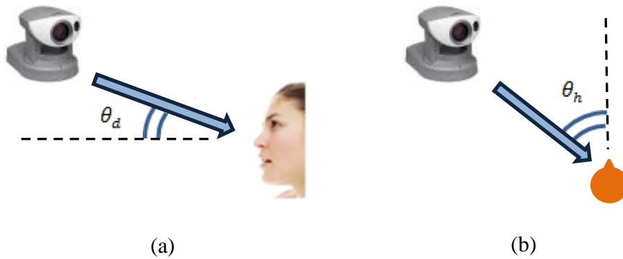
圖3.3 PTZ 攝影機架設角度示意圖 (a)垂直俯角 (b)水平偏差角
