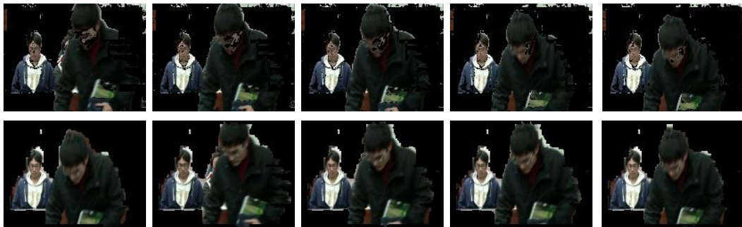
圖 2.10 改良 Chui 演算法之後前景擷取的結果。上排為取 global threshold 後之結果；下排為 graph cut 之後的結果。
