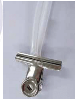
圖(3c)利用金屬夾將長管密封
