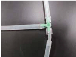
圖(1a) 三通閥與軟管連接 圖(1b) 氣球與軟管連接 圖(1c)調整三通閥逐一將氣球吹氣
