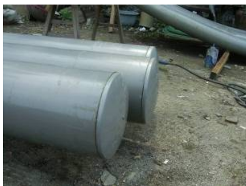
圖 5.6 組合膠管與管塞
