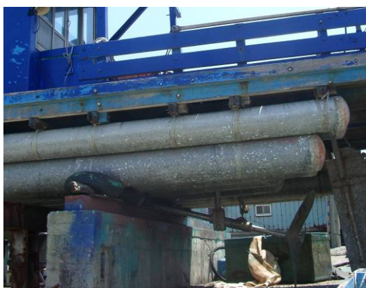
圖 5.12 雙層塑膠排仔尾端的萬向接頭
