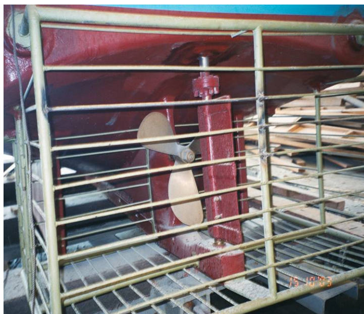
圖 5.13 使用美式圍網防止傳統螺旋槳打壞漁具
