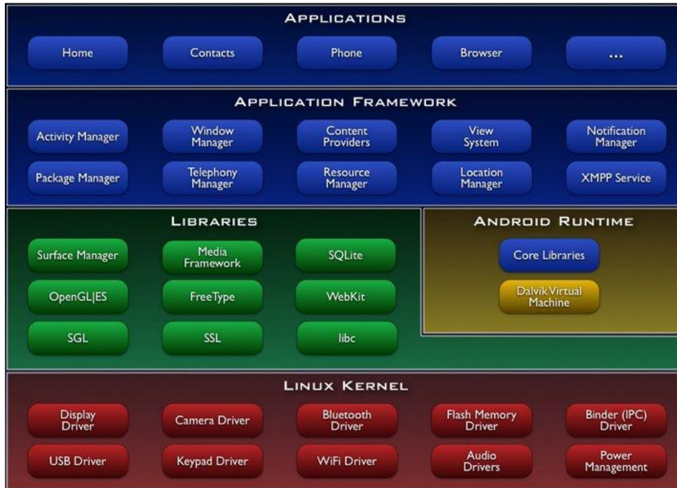
圖 2.1 Android 作業系統結構圖(資料來源：Android Developers[6])
