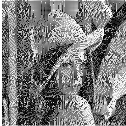
圖2-10: 以Folyd-Steinberg Error Diffusion(FSED)之半色調影像
