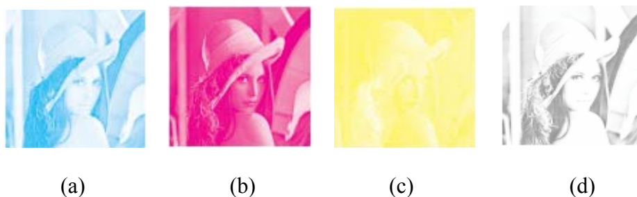
圖 2-15: CMYK 色彩模式(a)為 Cyan, (b)為 Magenta, (c)為 Yellow, (d)為 Black
